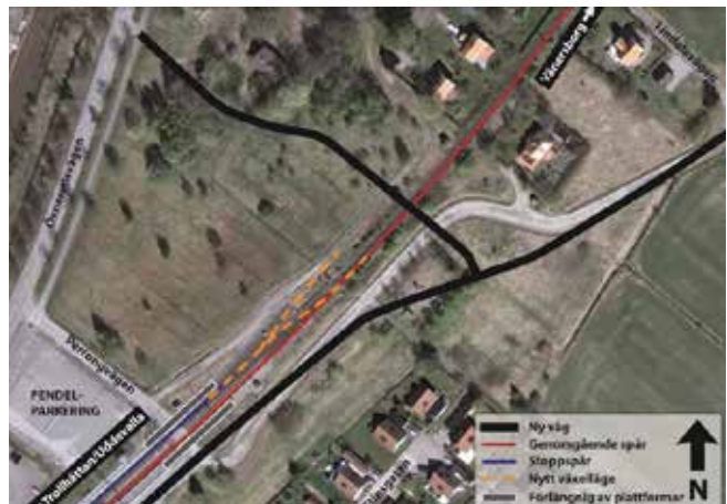
I samband med att vi bygger en ny plankorsning anpassar vi det lokala vägnätet till plankorsningens nya läge.
